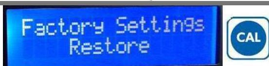
Stlačte a náhle uvoľnite tlačidlo CAL pre vstup do režimu programovania, potom stlačením tlačidiel + a - zvoľte položku „Obnova výrobných nastavení“.
