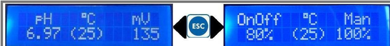
Počas prevádzky je možné zobraziť aktuálne hodnoty prietoku alebo dávok jednoducho stlačením tlačidla ESC. Zobrazenie môžete zmeniť opäťovným stlačením tlačidla ESC. (Pozri obr. vyššie)
